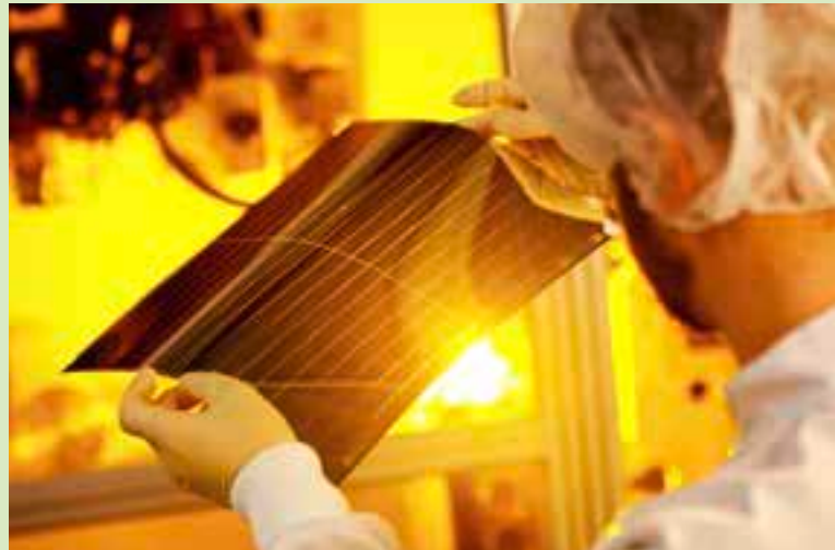
Die hauchdünnen Solarfolien aus der Produktionsanlage wiegen nur 500 g/m 2 und sind weniger als 1 mm dünn.
