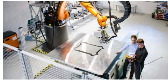
Anlage zum verschnittreduzierten Auftragen von Carbon- oder Glasfasern
